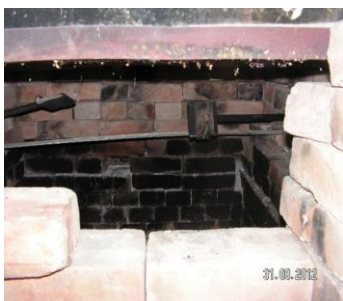
Фигура 15. Термодвойки за измерване на температурата в пещното пространство (фиг. 2.35 от дисертационния труд)
