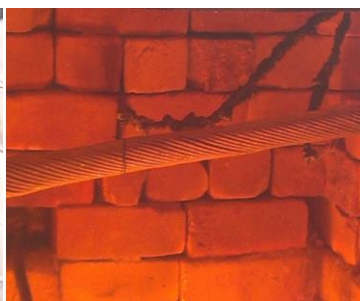
Фигура 16. Термодвойки, разположени в кабела (фиг. 2.36 от дисертационния труд)
