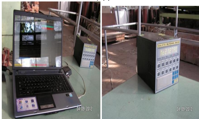
Фигура 17. Многоканален измервателен уред MD 100 TD 12 с notebook BENQ с „Digital system (фиг. 2.37 от дисертационния труд)
