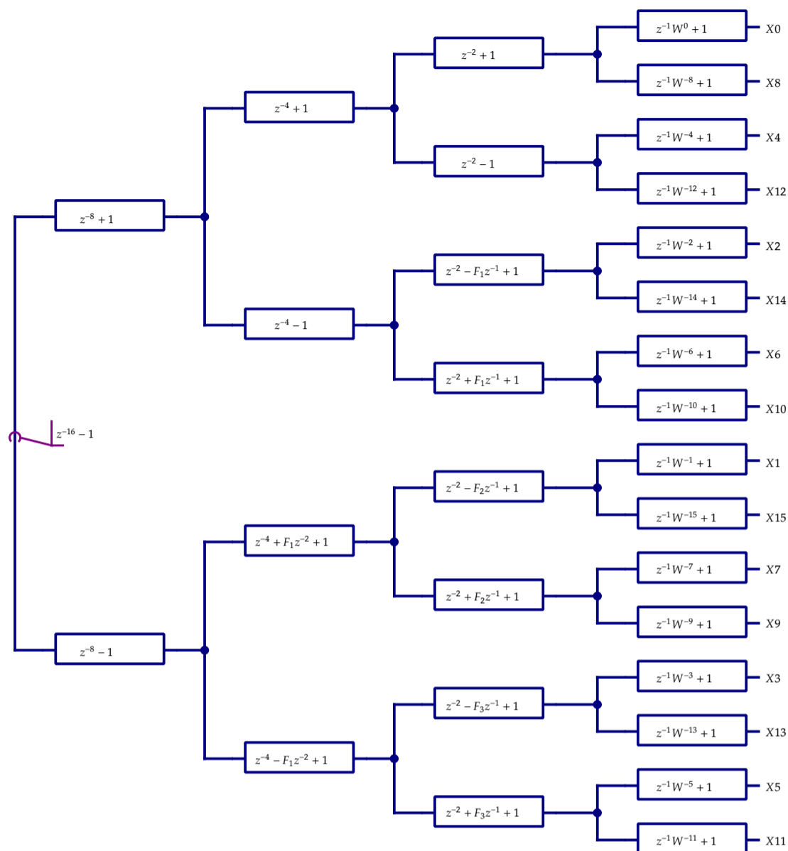
Фиг. 3.7. Алгоритъм на Брун с реални множители. F_1 = \sqrt{2} , F_2 = \sqrt{2 + \sqrt{2}} , F_3 = \sqrt{2 - \sqrt{2}}
