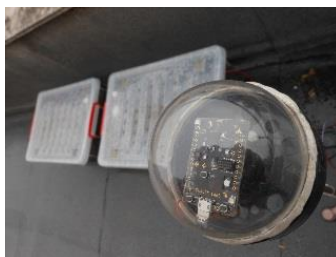
Фиг. 56 Снимка на устройство за екологичен мониторинг SLTB001A по време на работа
