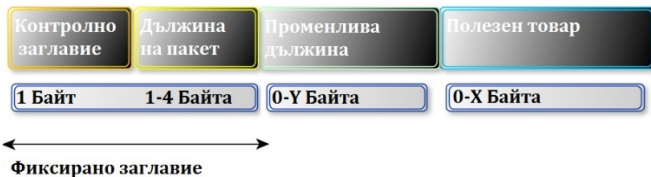
Фиг. 2.14. MQTT Пакетна структура
