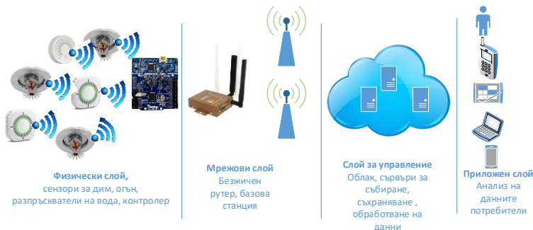
Фиг.3.1 Модел за интегриране на сензорни данни към облачна структура
